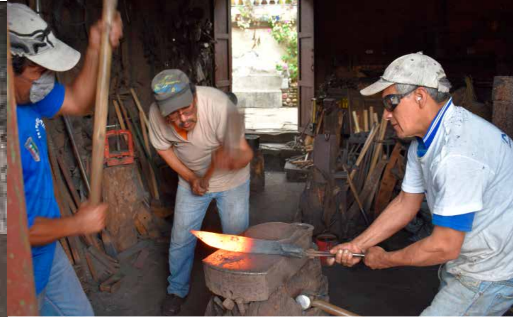
2. Forjado del hierro mediante golpes fuertes y rápidos.
