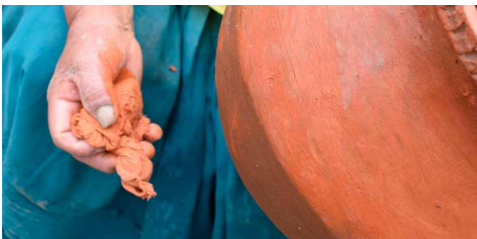
7. Esmaltado de la olla, antes del quemado en el horno.
