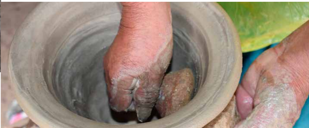
4. Formación de la olla con las huactanas (golpeadores)
