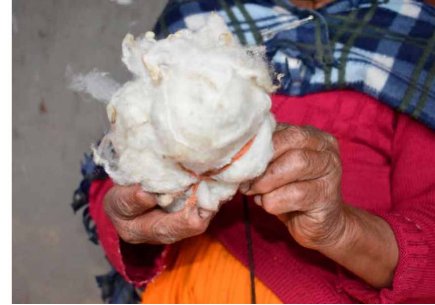
2. Estiramiento y retorcido de la fibra para formar el grosor del hilo deseado.
